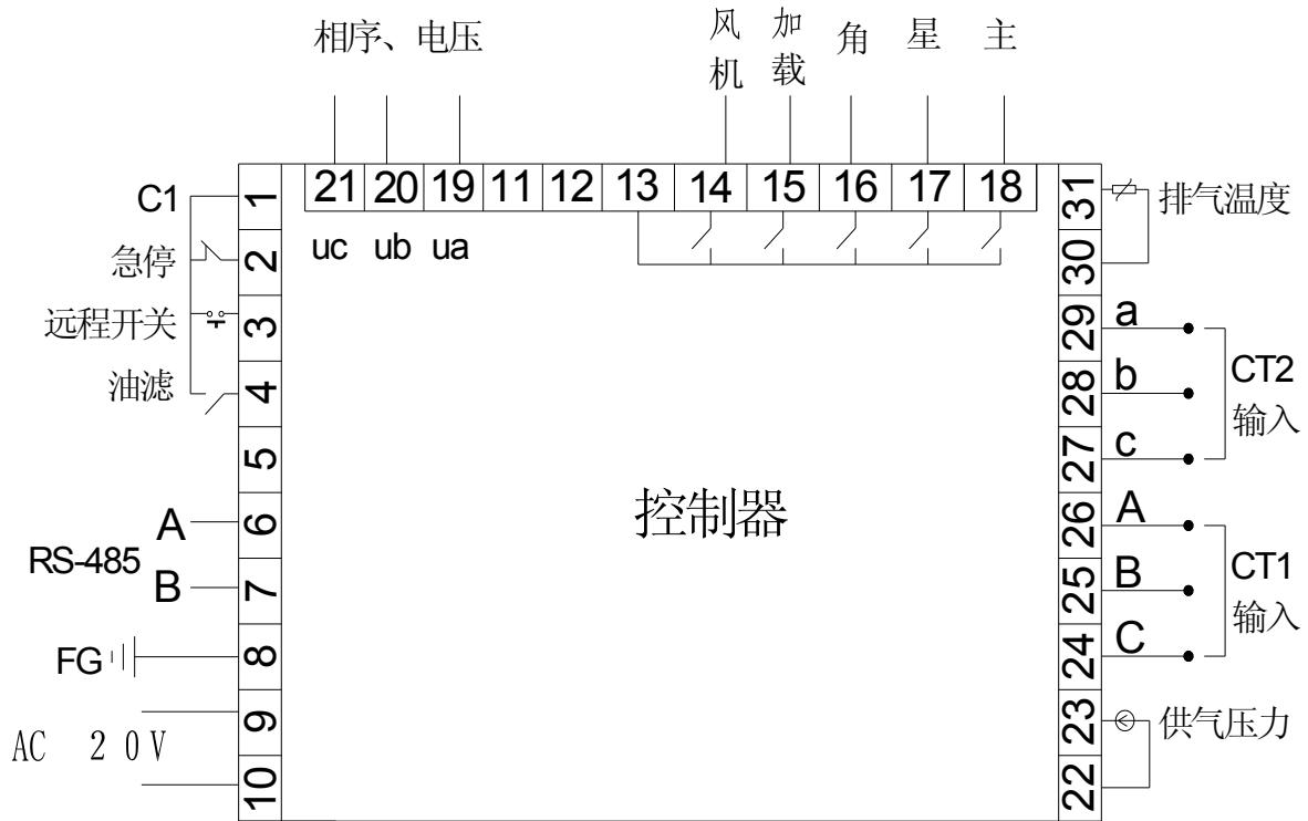
图 4.2.1、接线端子排列图
